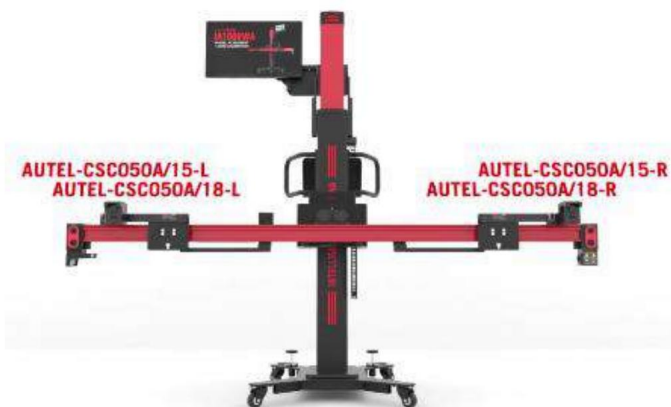
Slika 6-79 Namestitev podaljškov in dvorstičnih laserjev
