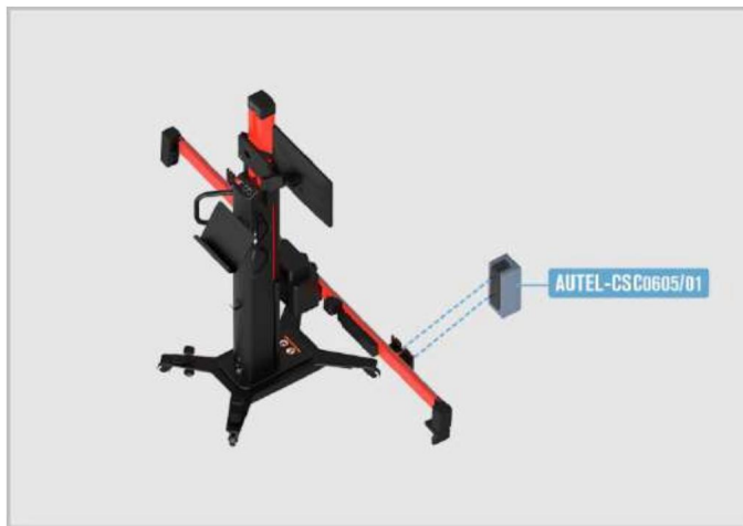
Slika 6-37 Namestitev kalibracijske škatle radarja na desno drsno ploščo
