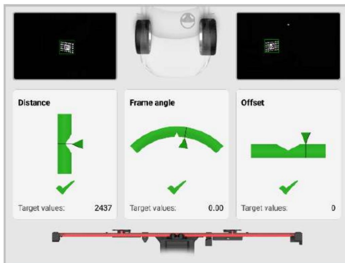
Slika 6-85 Prilagoditev kalibracijskega okvirja
