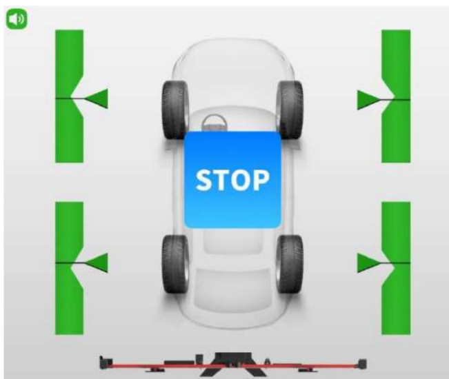
Slika 6-49 Kompenzacija kotaljenja koles 4
