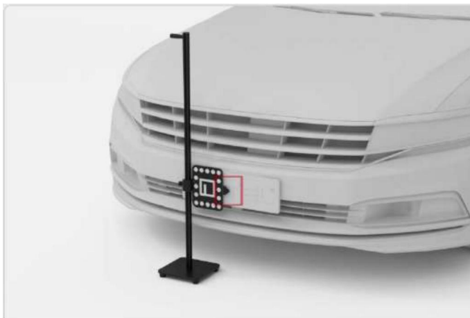
Slika 6-97 Namestitev pripomočka za poravnavo
