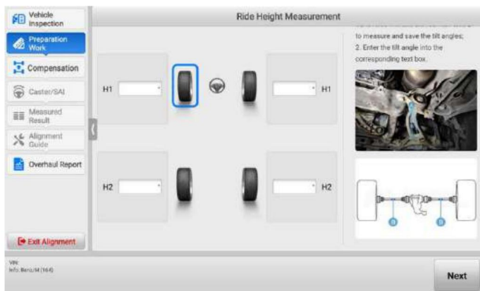
Slika 4-34 Merjenje in vnos kotov nagiba
