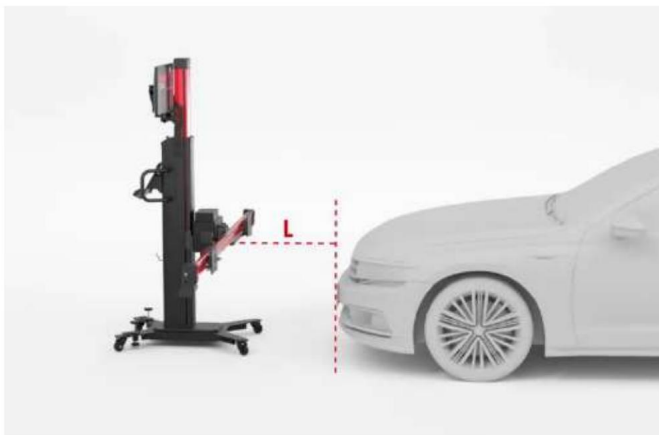
Slika 6-136 Centriranje kalibracijskega okvirja
