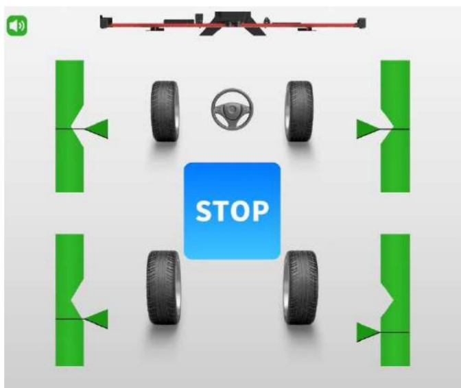
Slika 6-83 Kompenzacija kotaljenja koles 4
