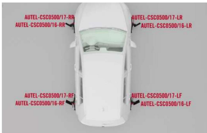
Slika 6-45 Namestitev sponk za kolesa (objemk za pnevmatike) in tarč
