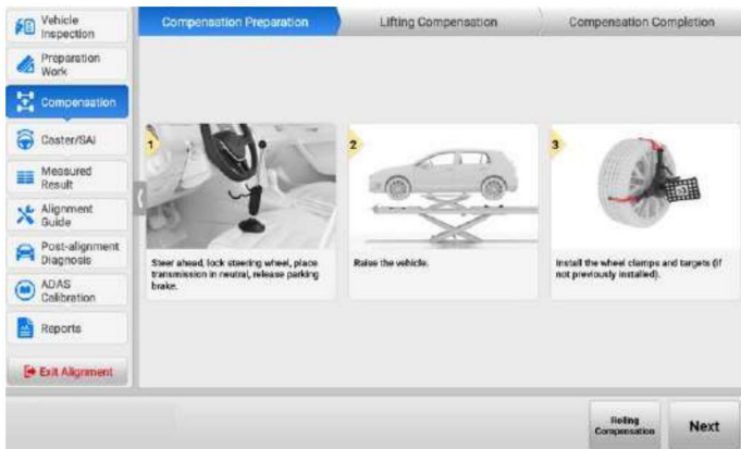
Slika 4-41 Priprava za kompenzacijo dvigovanja (uporabite objemko za pnevmatike)
