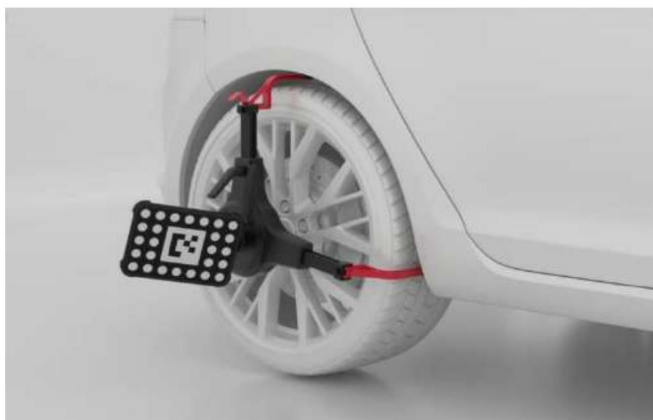
Slika 6-137 Namestitev sponk za kolesa (objemk za pnevmatike) in tarč
