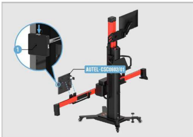
Slika 6-17 Prilagoditev reflektorja 1
