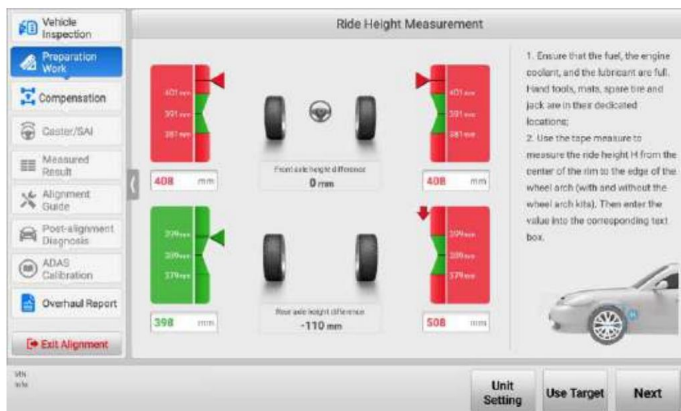
Slika 4-30 Merjenje višine vožnje z merilnim trakom 1
