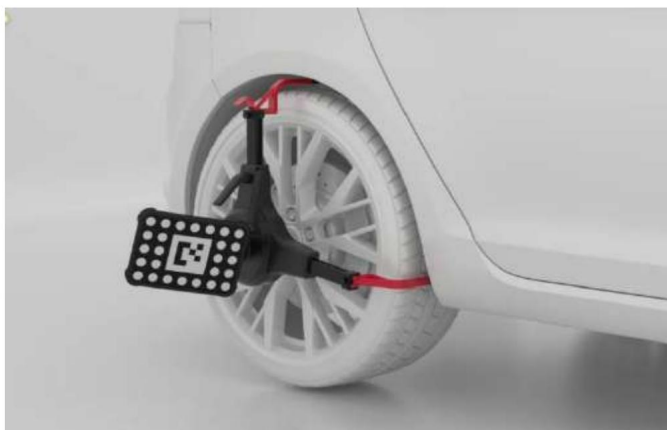
Slika 6-149 Namestitev sponk za kolesa (objemk za pnevmatike) in tarč
