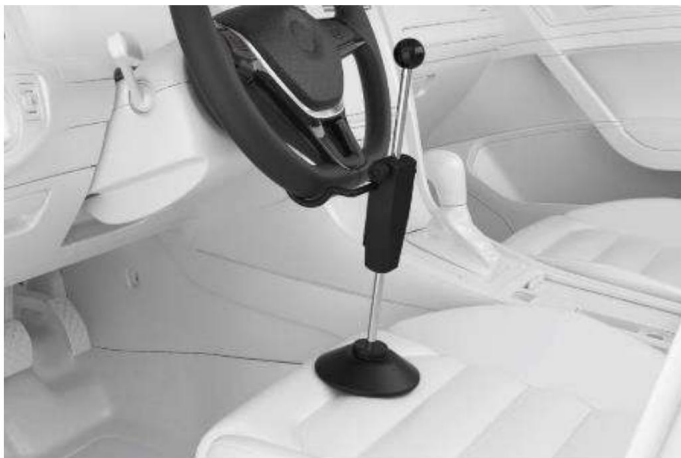
Slika 6-76 Namestite orodje za stojalo držala volana
