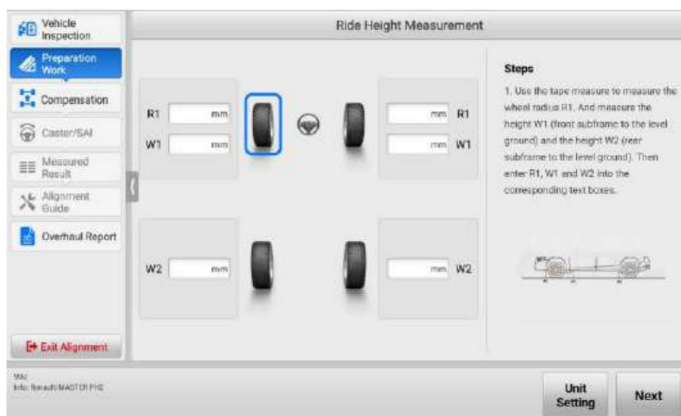
Slika 4-31 Merjenje višine vožnje z merilnim trakom 2
