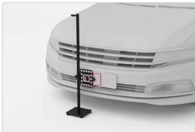
Slika 6-110 Namestitev pripomočka za poravnavo
