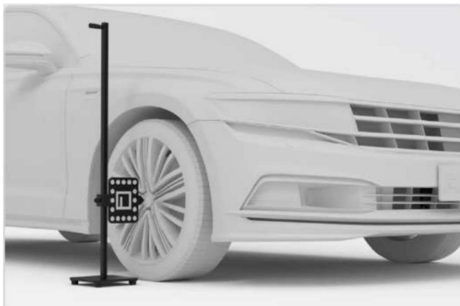
Slika 6-138 Namestitev pripomočka za poravnavo
