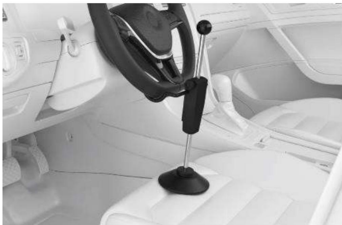
Slika 6-147 Namestite orodje za stojalo držala volana
