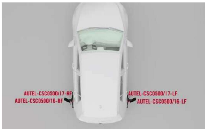
Slika 6-31 Namestitev sponk za kolesa (objemk za pnevmatike) in tarč
