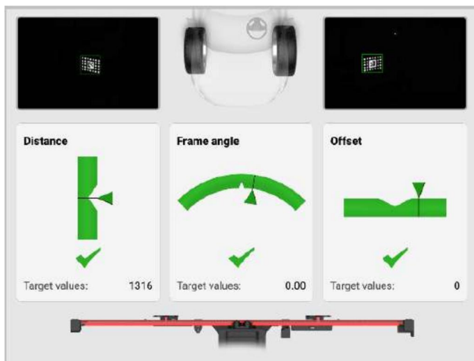
Slika 6-112 Prilagoditev kalibracijskega okvirja
