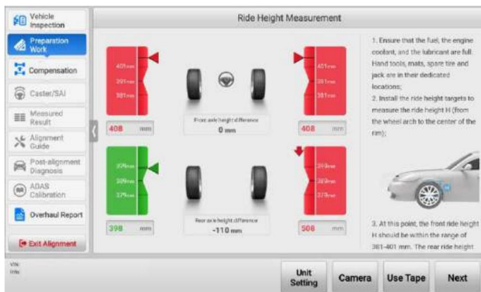
Slika 4-33 Merjenje višine vožnje s ciljno višino vožnje
