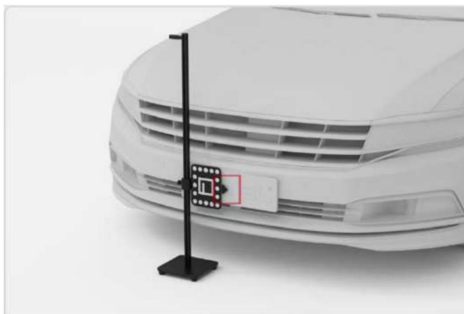
Slika 6-5 Namestitev pripomočka za poravnavo
